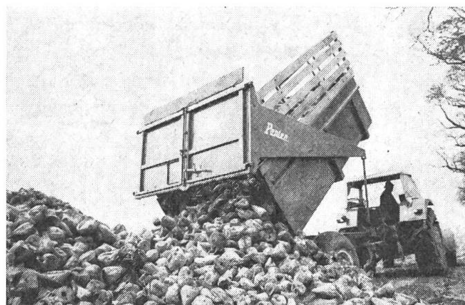
Die Einachskipper, in der Hitch gefahren, sind bewegliche Transporteinheiten; sie haben selbstöffnende Heckklappen und ermöglichen so Einmannarbeit beim Abladen.
