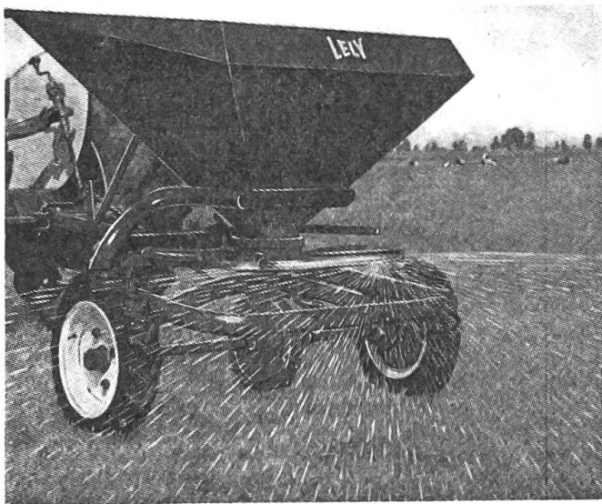
Abb. 6: Gezogener Einscheiben-Schleuderstreuer mit Bodenantrieb.
