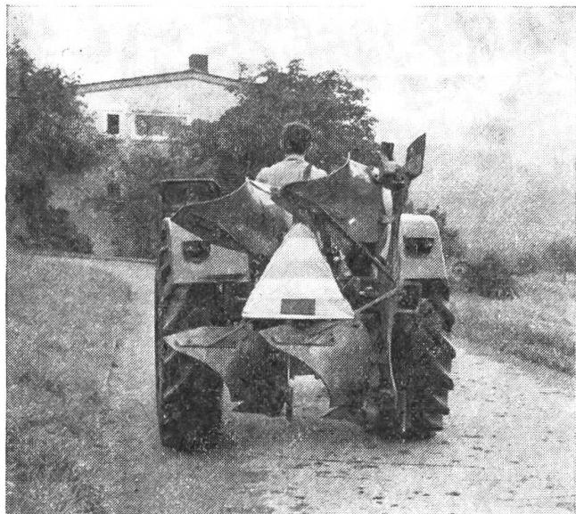
Strassenfahrzeugen» (BAV) in Art. 35, Abs. 4, vor. Sozusagen sämtliche Anbaugeräte sollen somit bei Fahrten auf öffentlichen Wegen und Strassen einen Signalkörper in Form einer Kugel oder Pyramide nach nebenstehender Abbildung aufweisen. Das Signal hat vor allem den Zweck, die Anbaugeräte gegenüber den schnelleren Strassenbenützern auffälliger zu machen, und ist damit geeignet, den Streif- und Auffahrkollisionen mit all ihren oft verhängnisvollen Folgen vorzubeugen.
