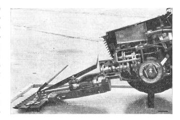
Abb. 9: Dieses Bild zeigt die «Innereien» des Fahrrad- und Messerantriebes eines Motormähers der gehobenen Leistungsklasse.
