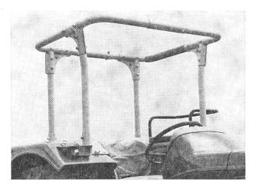
Sicherheitsrahmen, auf verstärkte Kotflügel abgestützt.
