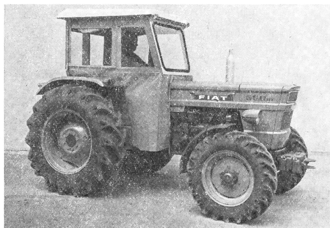
S-Rahmen mit Dach und hochklappbarer Frontscheibe. Er kann durch Anbringen von Seitenteilen zur Kabine ergänzt werden.
