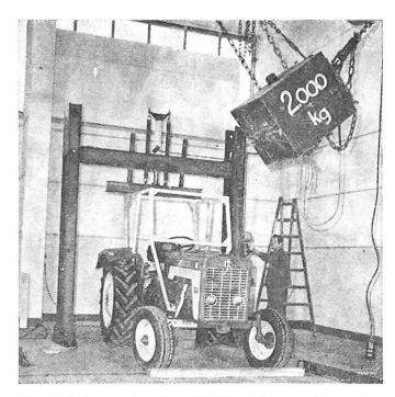
Ein S-Rahmen in der OECD Prüfung. Vorn das Pendel, das gegen den Rahmen schlägt und hinten die hydraulische Presse, welche den Rahmen mit dem doppelten Gewicht des Traktors zusammendrückt.
