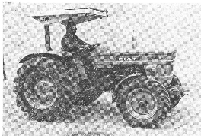
S-Kabine, mit guter Sicht nach vorn und Seitenteilen zum Öffnen.
