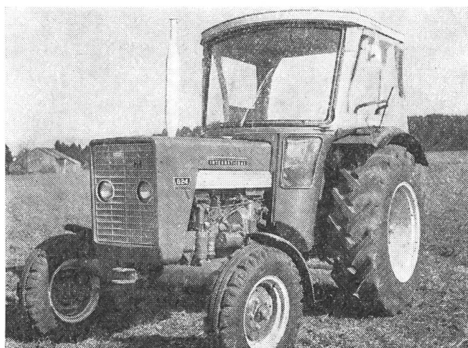
Mit Wetterschutzverdeck versehener Rahmen. Einstiegsmöglichkeit von vorn.
