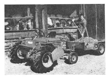
Abb. 8:... bei der Verwendung als Universal-Kleintraktor. In dieser Eigenschaft bieten sich für ihn viele Einsatzmöglichkeiten auf dem Feld, auf dem Hof oder auf der Strasse. Der Schnellmäher weist eine Standard-Traktorspur auf. Das verleiht ihm bei niedrigem Schwerpunkt gute Sicherheit und Geländegängigkeit. Im 4. Gang erreicht er 20 km/h.
