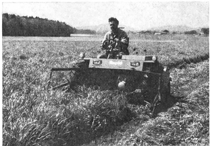
Abb. 1: ...erreicht bei einer Arbeitsgeschwindigkeit bis 10 km/h und einer Mähbreite von 2 m ausserordentliche Mähleistungen. Die Futtermverschmutzung ist auf ein Minimum reduziert und die Grasnarbe bestens geschont.
