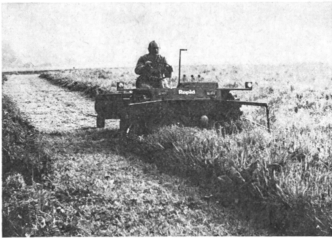
Abb.3: ...beim Mähen und Schwadenziehen von schwerem Silofutter während einer Schlechtwetterperiode. Das Futter wird anschliessend direkt vom Feldhäcksler aufgenommen und nach dem Einbringen nass siliert.
