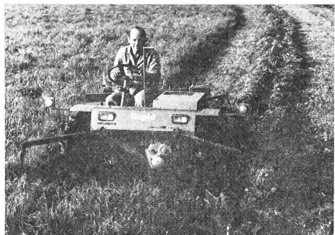
Abb. 2: ...beim Mähen und Schwadenziehen von Grünfutter in einem Arbeitsgang. Je nach Futterart arbeitet die «Heureka» im zweiten oder dritten Gang.
