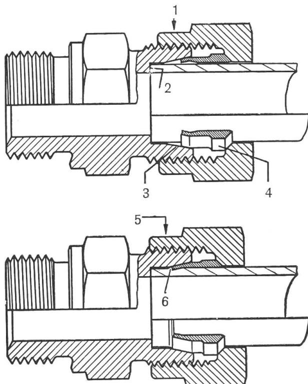
Der harte Schneid- und Keilring gleitet beim Anzug der Überwurfmutter am Innenkonus des Stutzens entlang, verjüngt sich und schneidet unter Aufwurf eines sichtbaren Bundes in das Rohr ein. Es ist unbedingt erforderlich, dass das Rohr gegen den Anschlag im Innenkonus stösst, da sonst der Schneidvorgang nicht erfolgen kann.
