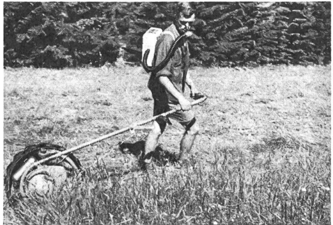
Abb. 4: Diesen Einradmäher hat man auch für Bergbauern propagiert. Wegen der geringen Flächenleistung und Hangtauglichkeit scheidet er aber für diese Arbeiten aus. Der Bedienungsmann ist mit einer Respirationsgasuhr ausgestattet, um den Kraftbedarf während des Arbeitens feststellen zu können.
