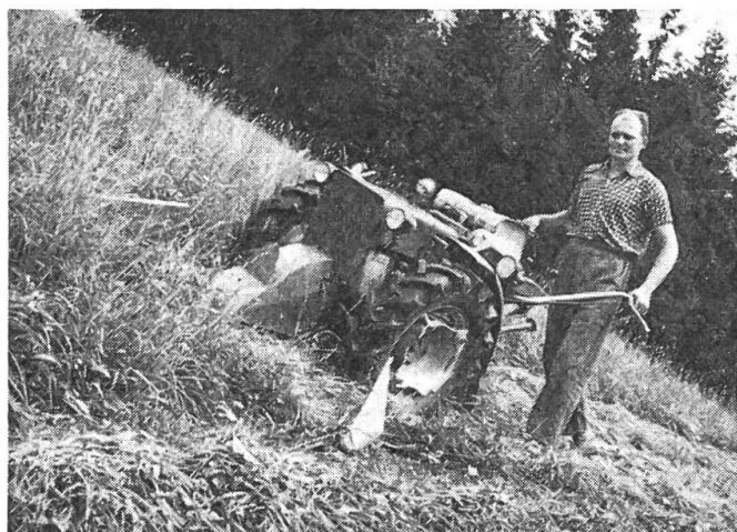
Abb. 3: Grundsätzlich handelt es sich hier um einen Einachstraktor, der mit einem 1,9 m breiten Mähbalken ausgestattet ist.
