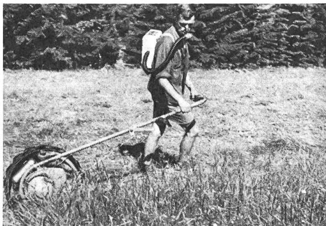
Abb. 4: Diesen Einradmäher hat man auch für Bergbauern propagiert. Wegen der geringen Flächenleistung und Hangtauglichkeit scheidet er aber für diese Arbeiten aus. Der Bedienungsmann ist mit einer Respirationsgasuhr ausgestattet, um den Kraftbedarf während des Arbeitens feststellen zu können.
