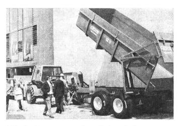
Abb. 2: Kippwagen aufgesattelt auf Grossgeräteträger (Deutz).
