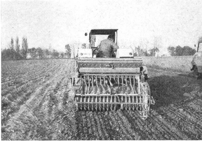
Abb. 1: Frässämaschine mit geschlossener Scheibenwalze, die auch zur Einstellung der Arbeitstiefe dient.
