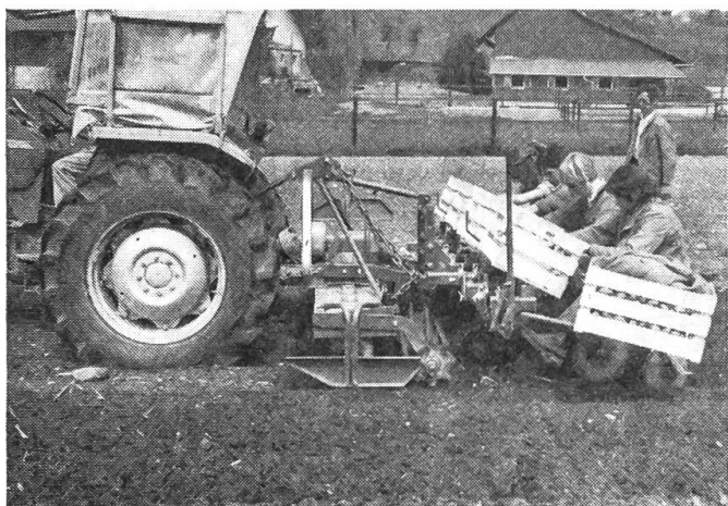
Abb. 5: Bestellsetzen der Kartoffeln mit Kreiselegge und halbautomatischem Setzgerät.
