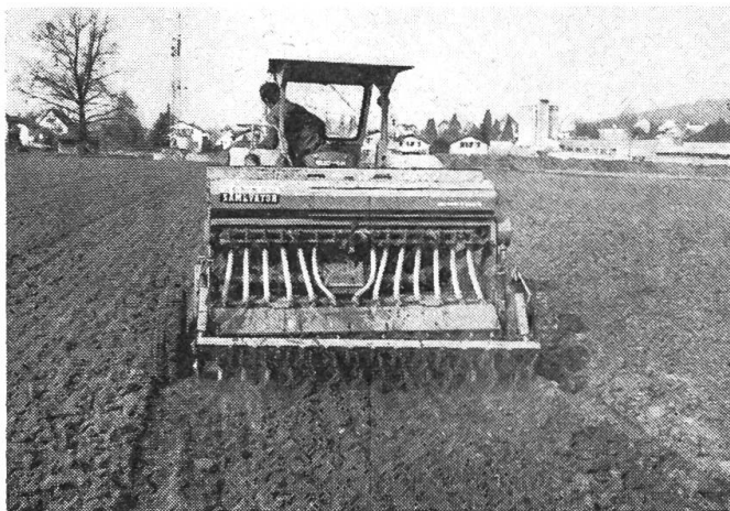
Abb. 2: Frässämaschine mit offener Scheibenwalze (Krumenpacker). Die Einstellung der Arbeitstiefe erfolgt hier durch Stützräder.
