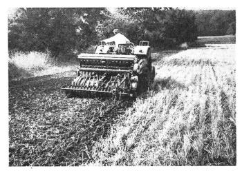
Abb. 3: Direktsaat mit Frässämaschine für Zwischenfrucht.
