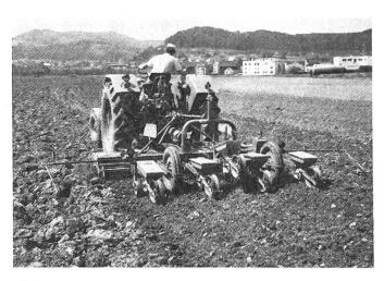
Abb. 6: Mais-Bestellsaat: Kreiselegge mit Einzelkornsämaschine.
