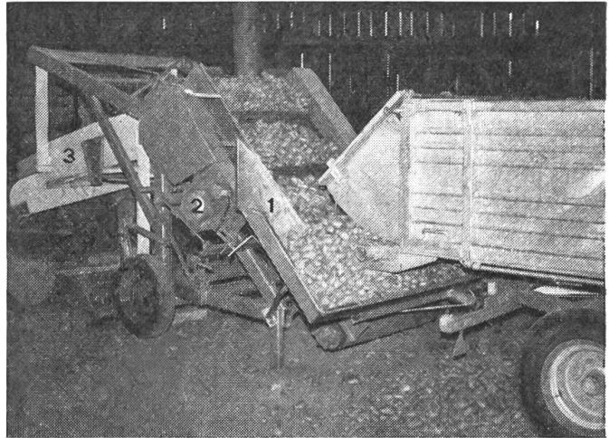
Abb. 5: Bei der für die Versuche verwendeten Sortiermaschine «Cheveux» sind ersichtlich: Zubringerband mit Grosstrichter (1), Antriebsmotor mit Variator (2), Siebkasten mit Quadratmaschensieb und Erdrost (3).
