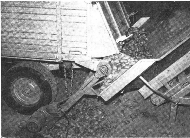
Abb. 4: Der Abladeteppich ermöglicht ebenfalls eine direkte Beschickung der Sortiermaschine. Dank dem einstellbaren Vorschub lässt sich die Ablademeenge genau regulieren.
