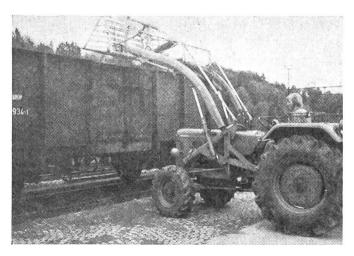
Abb. 4: Ein Frontlader kann auch für die Waggonbeladung gut eingesetzt werden.
