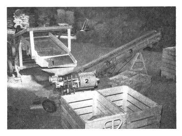
Abb. 6: Einrichtung zum Abfüllen der Paloxen: Sortiermaschine — Auslauftrog für Grossknollen (1), schwenkbares Förderband zur wechselweisen Paloxenbeschickung (2), Förderband für Kleinknollen (3).
