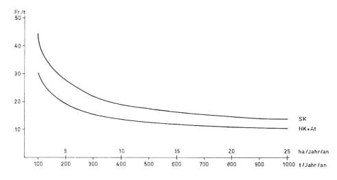
Abb. 7: Maschinen- und Arbeitskosten beim Transport, Umschlag und Sortieren der Erntekartoffeln. Verfahren:
