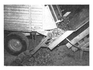
Abb. 4: Der Abladeteppich ermöglicht ebenfalls eine direkte Beschickung der Sortiermaschine. Dank dem einstellbaren Vorschub lässt sich die Ablademenge genau regulieren.
