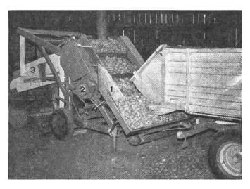
Abb. 5: Bei der für die Versuche verwendeten Sortiermaschine «Cheveux» sind ersichtlich: Zubringerband mit Grosstrichter (1), Antriebsmotor mit Variator (2), Siebkasten mit Quadratmaschensieb und Erdrost (3).
