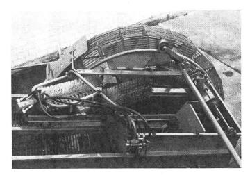
Abb. 2: Steintrenn-Aggregat für doppelte Trennung mit verlängertem Fingerband und 2. Trennbürste (Schutzvorrichtung abgenommen).
