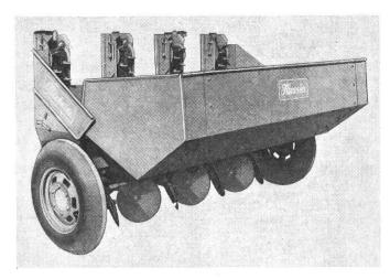
Abb. 1: Legeautomat GLB mit Doppelbecherwerk und Vorratsbunker.
