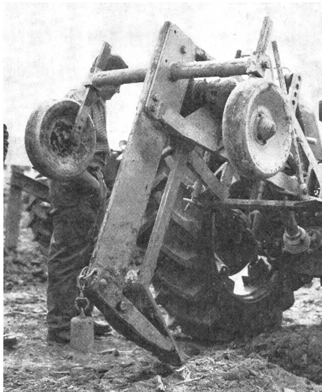
Abb. 1: Untergrundlockerern mit Wippschar. Er kann den Boden bis 90 cm tief lockern.
