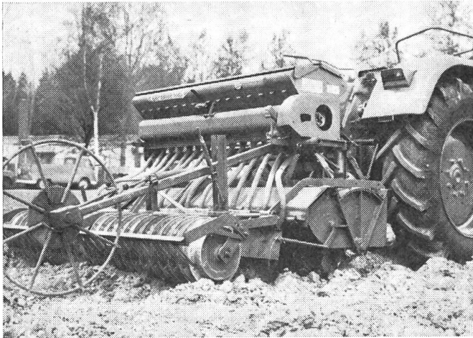
Abb. 4: Fräs-Sämaschine mit nachlaufender Trag- und Verdichtungswalze.
