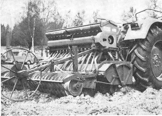
Abb. 4: Fräs-Sämaschine mit nachlaufender Trag- und Verdichtungswalze.
