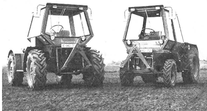
Bild 1: Die beiden neuen Arbeitsmaschinen des INTRAC-SYSTEM's 2000. Links der INTRAC 2005 mit 5 Zylinder-Motor (80 PS) und hydrostatischem Antrieb. — Rechts der INTRAC 2002, aufgebaut auf konventionellen Bauteilen der Serie 06 (Motor, Getriebe, Hinterachse) mit 50 PS-Leistung. Für beide Varianten soll eine Erweiterung der Serien vorgesehen sein.
