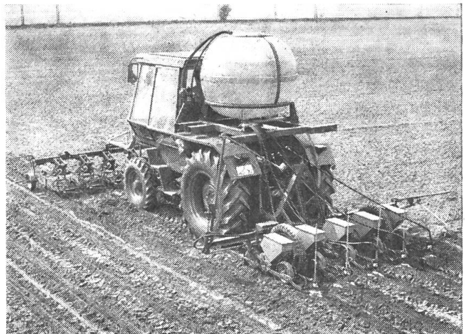
Bild 4: Der Zentralaufbauahmen kann sowohl mit den zum Transport der Hilfsstoffe benötigten Behältern, als auch mit einer Sattelschlepperkupplung versehen werden.
