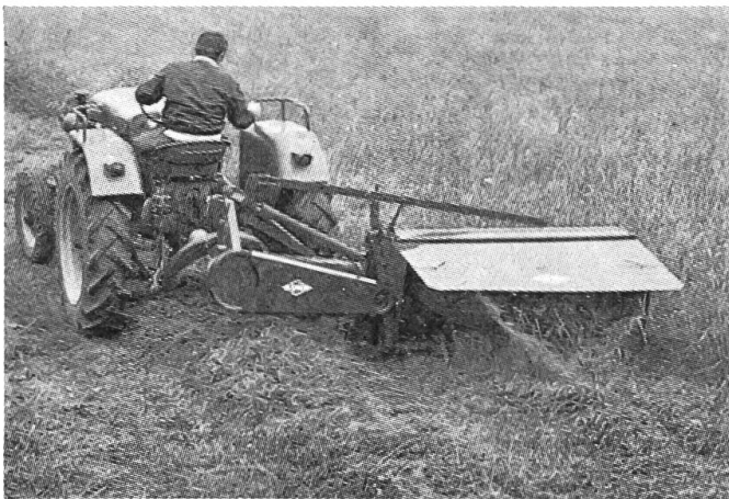
Abb. 9: Mit dem Mähquetschzetter wird das gemähte Futter gequetscht und breit verteilt, wodurch der Trocknungsvorgang wesentlich begünstigt werden soll.
