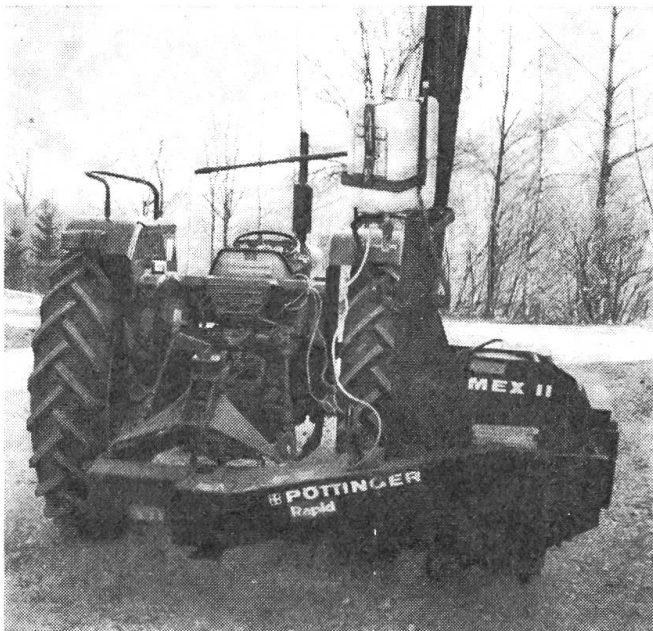
App. 4: Pflückschroter mit billigen, direkt aufgebautem «LTI»-Säuredosiergerät. Die Dosierung erfolgt ebenso gleichmässig wie mit teuren Propionsäuredosiergeräten; allerdings sollte für Beimengungen von über 1 % ein Behälter mit 40–50 l Inhalt vorhanden sein.
