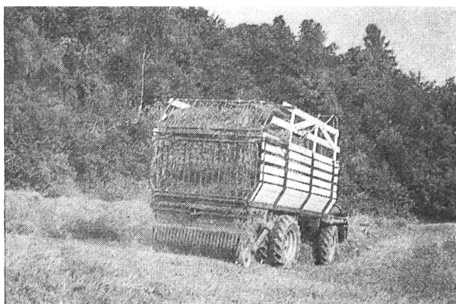
Abb. 2: Beim Ladetransporter ist das Pick-up hinten am Fahrzeug. Es ist gut zugänglich und eignet sich deshalb gut, um im Stand zu beschicken. Dies ist wichtig, wenn nicht-befahrbare Böschungen abgeerntet werden müssen.
