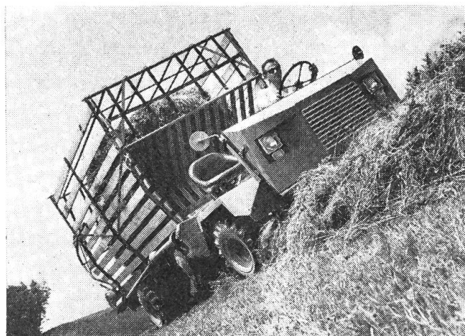
Abb. 3: Beim Selbstfahrladewagen befindet sich das Pick-up vor oder hinter der Vorderachse. Bei der Umrüstung zu Transportarbeiten müssen Seitenwände und Ladeorgan demontiert werden.
