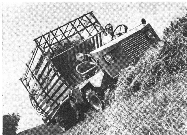
Abb. 3: Beim Selbstfahrladewagen befindet sich das Pick-up vor oder hinter der Vorderachse. Bei der Umrüstung zu Transportarbeiten müssen Seitenwände und Ladeorgan demontiert werden.
