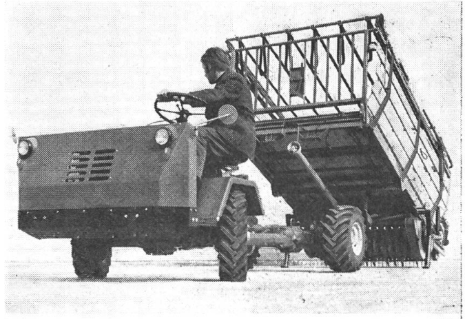
Abb. 1: Beim Ladetransporter kann das Ladegerät sehr einfach abgekoppelt und eine Brücke aufgesattelt werden.
