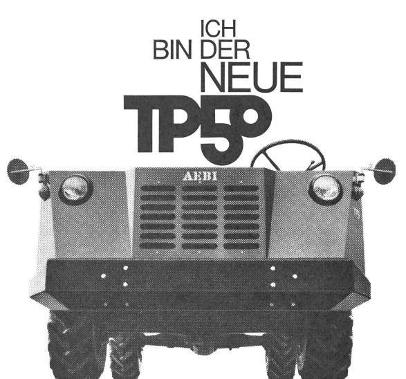
... der neue AEBI-Transporter TP 50 mit 42 PS Perkins-Dieselmotor, ein Vielzweckfahrzeug, das seinesgleichen sucht. Solid, robust und zäh. Praktisch — so richtig für den Einmannbetrieb ausgerüstet. In weniger als 3 Minuten sind Brücke, Ladegerät, Miststreuer oder Saug- und Druckfass auf- und abgebaut, und zwar bequem von einem einzigen Mann!
