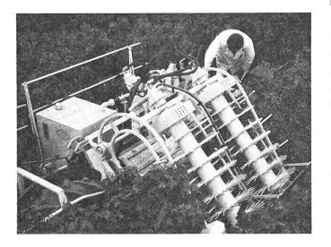
Eine britische Firma hat den abgebildeten Prototyp zu einer Erntemaschine für schwarze Johannisbeeren entwickelt. Sie soll es ermöglichen, die Früchte ohne Beschädigung des Strauches zu ernten, indem sie die Beeren buchstäblich abschüttelt. Es sollen damit bei normalem Behang 1 Tonne Beeren gepflückt werden können.
