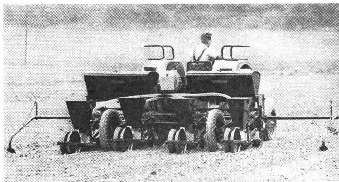
Die neue Erntemaschine wird an das Dreipunktgestänge des Traktors angebaut. Das eigentliche Ernteaggregat besteht aus einem Rahmen mit zwei rohrförmigen Rüttelzylinbern. Die übrigen Einzelheiten können teilweise der Abbildung entnommen werden. Da es sich um einen Prototyp handelt ist noch nicht jedes Detail bekannt.
