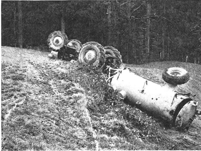
Abb. 1: Pump- und Druckfässer stürzen leicht und damit in der Regel auch der Traktor. Wenn Zugmaul und -öse starr sind (im vorliegenden Fall traf dies nicht zu) besteht besonders grosse Gefahr, dass der Traktor zwangsläufig überzogen wird. Deshalb gilt: Wenn Zugmaul starr, dann Oese drehbar, oder: Wenn Zugmaul drehbar, dann Oese starr. Beides soll nicht starr oder drehbar sein.
