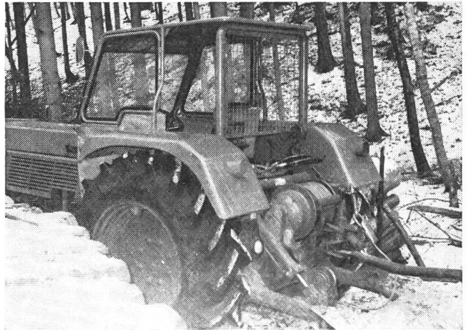
Abb. 3b: Wetterverdeck kombiniert mit Sicherheitsbügel. In der Waldwirtschaft und im Obstbau würde sich eine starke Ausbuchtung nach Abb. 3b arbeits-hinderlich auswirken. Im allgemeinen dürfte die richtige Ausbuchtung zwischen den beiden Ausführungen von Abb. 3a und Abb. 3b liegen. Man beachte auch das Fanggitter, das als Schutz gegen nachstossende Lasten (einzelne Holzstücke) dient.
