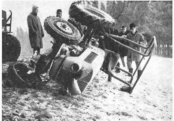
Abb. 3a: Der gestürzte Traktor bleibt zufolge starker Ausbuchtung oben am Rahmen auf der Seite liegen.
