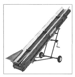
Schleiftype, auf Aluminium-Boden, Gurtbreite 300 mm, für Leichttransporte (Hühner- und Kälbermist, Siloentnahme usw.), auch mit Fahrgestell lieferbar, 5 m Band, wiegt bloss 60 kg, Gurt aus Kunststoff oder Gummi.
