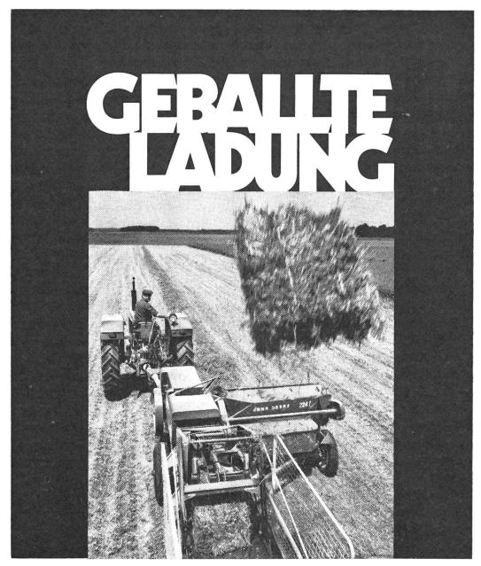
Grosse Ballen, kleine Ballen. Mit der John Deere Hochdruckpresse 224 ist das kein Problem mehr. Sie können bei dieser Presse die Grösse der Ballen stufenlos einstellen. Von 0,30 bis 1,27 m.
