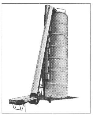
für grosse Förderleistung bei wenig Kraftbedarf, auch bei engen Platzverhältnissen. Leistung: bei 3–4 PS 60 m³/h. 72ºansteigender Förderung mit geschlossener Aluminium-Abdeckung. Für Offentransport, z. B. Ballen, ist die Alu-Abdeckung leicht abnehmbar. Neigungswinkel von 25º-72º. Beidseitig abrollende, hochwertige Rollenkette (Bruchfestigkeit 5,4 t).
