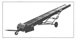
das leistungsfähige Ganzjahresgerät in neuer statisch vollwertiger Leichtbauweise (& Pat.), hochverschleissfeste Kunststofführungen, quitsch- und aufwickelfrei, Stirnradgetriebe mit 4 Geschwindigkeiten und Zapfwelle, elektr. Ausrüstung — alles im Chassis geschützt eingebaut, das meistgekaufte und preisgünstige Qualitätsförderband auf dem Markt (& Pat.).
