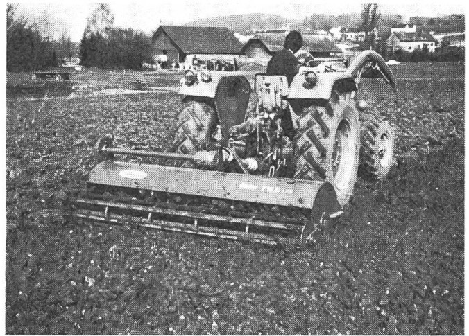
Abb. 3: Eine Taumelwälzegen mit Stabwalze wird für die Saatbettvorbereitung von schwer absetzbaren Böden bevorzugt.
