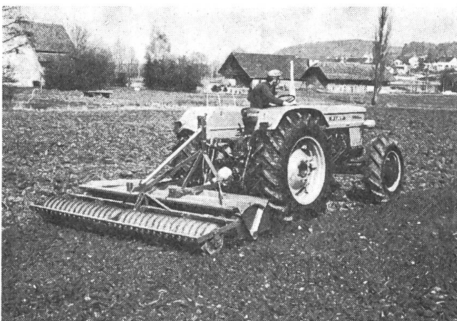
Abb.4: Bodenfräse mit Scheibenwalze bei der Saatbettherstellung.
