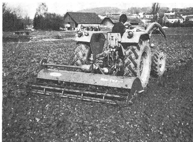
Abb. 3: Eine Taumelwälzge mit Stabwalze wird für die Saatbettvorbereitung von schwer absetzbaren Böden bevorzugt.
