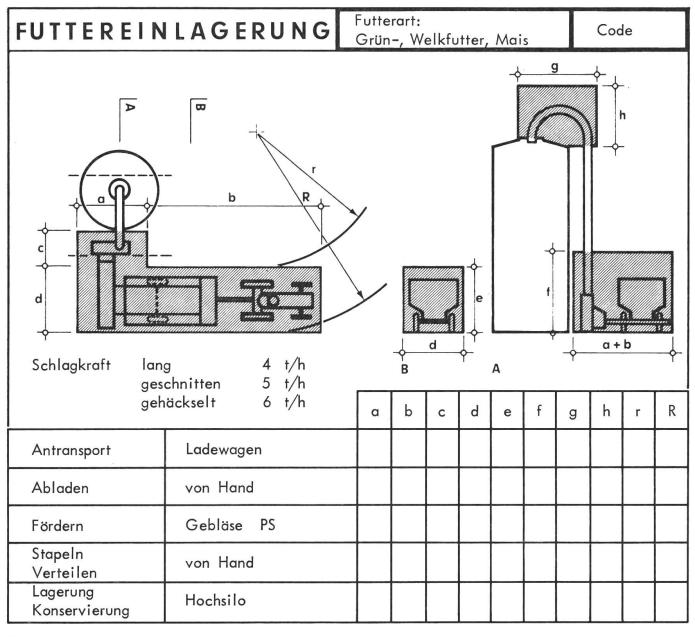
Abb. 2: Beispiel eines Katalogblattes für funktionelle Daten (Standardblock).
