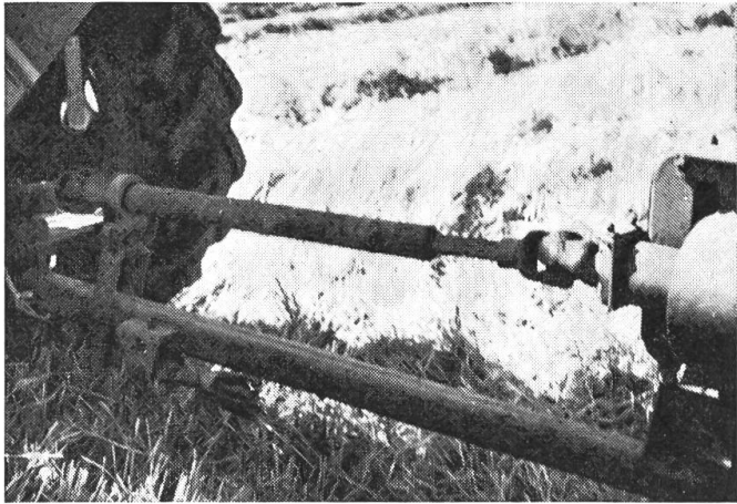
Abb. 7: Überbetrieblich eingesetzte Maschinen sol- len keinen direkten Anlass zu Unfällen bieten. Dazu müssen sie die notwendigen Schutzvorrich- tungen aufweisen. Geschützte Gelenkwellen stehen im ABC der Unfallverhütung am Anfang. Nicht weniger wichtig als eine Kette für den Antrieb einer Maschine ist die gesunde leistungsfähige Arbeitskraft.
