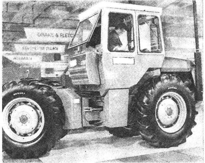
Abb. 2: Echter Allradantrieb, Knicklenkung und Gewichtsverlagerung auf die Vorderräder zeichnen Grosstraktoren aus.
