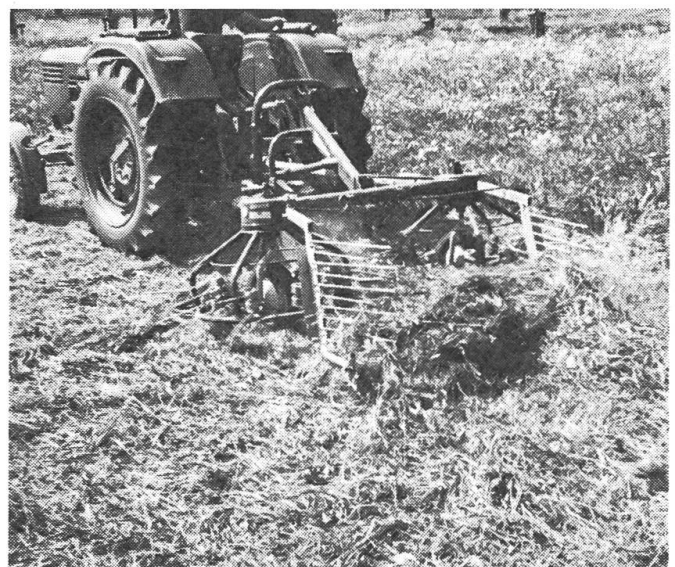
Abb.5: Kombinationsmaschinen sind nicht selten Kompromissmaschinen. Aus Gründen der grösseren Auslastung entschliesst man sich, im Vergleich zur Spezialmaschine, zur qualitativ schlechteren Arbeit. Im überbetrieblichen Einsatz werden Spezialmaschinen eher rentabel.
