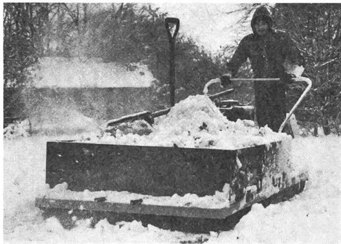
Auf einem Luftkissen gleitet die Hoverpallet über Schnee, Eis oder sumpfiges Gelände. Hier wird das praktische Fahrzeug zum Schneeräumen eingesetzt. (BFF)
