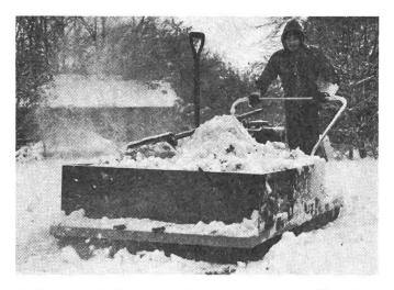
Auf einem Luftkissen gleitet die Hoverpallet über Schnee, Eis oder sumpfiges Gelände. Hier wird das praktische Fahrzeug zum Schneeräumen eingesetzt. (BFF)
