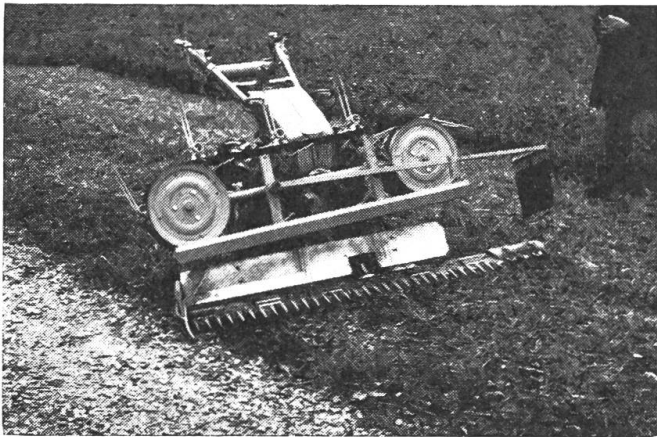
Abb. 1: Die neue Eingrasvorrichtung von Rapid auf dem Prinzip des Bandrechens, vorgestellt von Konrad Wepfer, Leiter der Entwicklungsabteilung. Um ein Verstopfen des Balkens zu verhindern, sind an einem Ende Mulchfinger angebracht worden.
