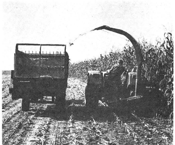
Abb. 3: Neuzeitliche Maiserntekette: am Traktor angebauter Maishäcksler und einachsiger Häckselwagen mit seitlicher Austragvorrichtung zum Beschicken von Gebläsen, Förderbändern oder Krippen.
