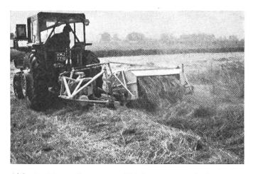
Abb. 2: Neuartige vom N.I.A.E. entwickelte Heuerntemaschine (Prototyp) zum Mähen und Konditionieren von Heugras zur Beschleunigung des Trocknungsvorganges.
