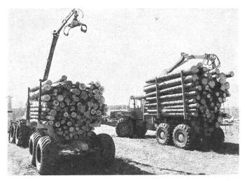
Abb. 4: Knickschlepper und Raupenschlepper bei Transportarbeiten.
