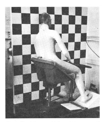
Abb. 4: Simulation von Traktorschwingungen auf dem Traktorsitz-Prüfstand.
