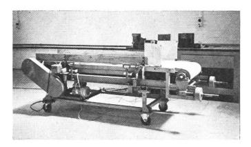
Abb. 7: Detail Förderband mit elektronischer Durchlaufwägung.
