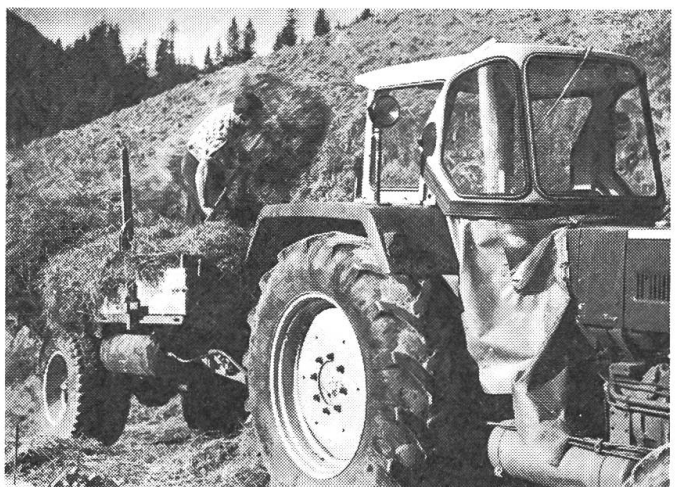
Abb. 3: Forstanhänger im Einsatz in der Landwirtschaft. Man beachte u. a. die Luftdruckbremsanlage und die Sicherheitskabine.
