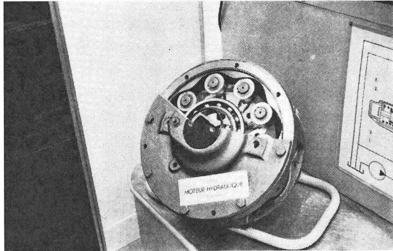
Abb. 3: Schnittmodell «Hydraulik- motor»
