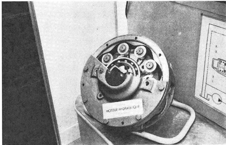
Abb. 3: Schnittmodell «Hydraulik- motor»
