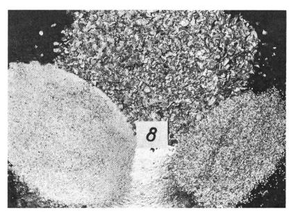
Abb. 3: Aussiebung eines extra groben Schrotes, der aus gedroschenen Maiskörnern erzeugt wurde.
