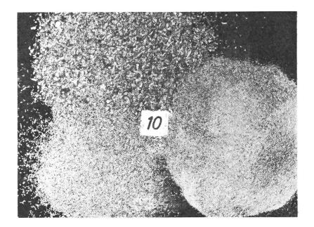
suchen, welche Schrotfeinheit aus fütterungstechnischen und siliertechnischen Rücksichten gefordert werden muss. Die Forderung nach einem zu feinen Schrot verringert die stündliche Mahlleistung und erhöht die Motorleistung unnötig. Ein zu grober Schrot wird wahrscheinlich den Fütterungserfolg schmälern.
