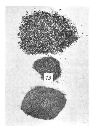
Abb. 2: Aussiebung eines Schrotes, der durch Vermusung ganzer Maiskolben erzeugt wurde.
