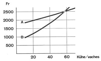
Abb. 16: Kosten für die maschinentechnischen Einrichtungen bei reiner Dürrfuttereinlagerung.
