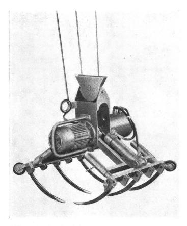
Abb. 14: Hydraulisch betätigte Greiferzange.
