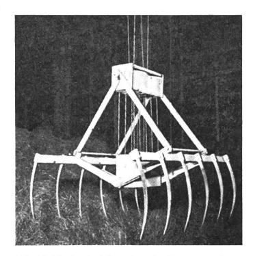
Abb. 13: Mechanisch betätigte Greiferzange mit einer Zweiseilwinde.
