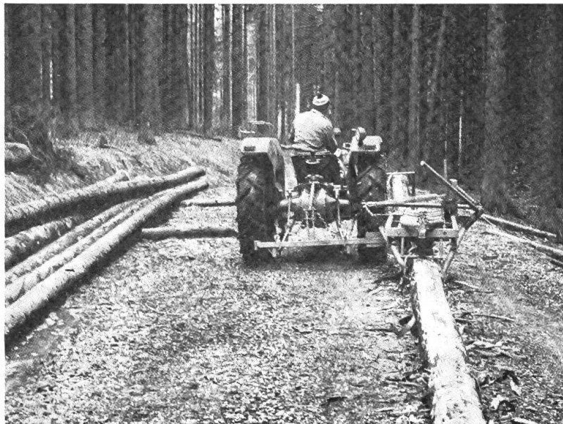
Abb. 3: Landwirtschafts-Traktor mit Holzentrindungsgerät «Rindab».
