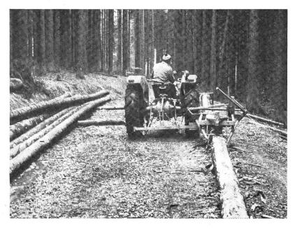
In letzter Zeit macht das neue Holzentrindungsgerät «Rindab» von sich reden. Sein Hauptvorteil liegt darin, dass dessen Führung mit Hilfe eines Traktors erfolgt. Dabei unterbleiben die bei handgeführten Entrindungsmaschinen typischen Schädigungen der Arbeiter durch Lärm, Vibration und Abgase.
