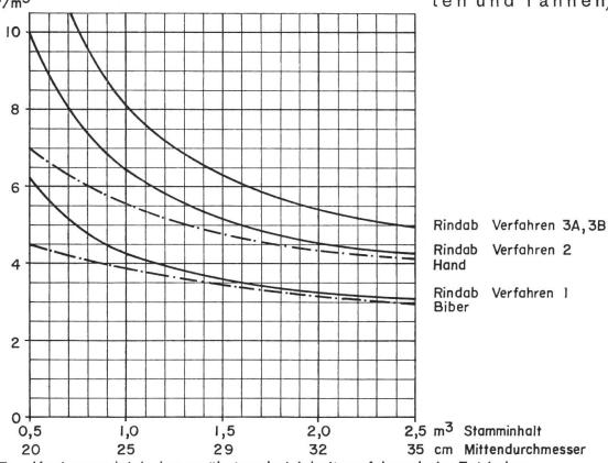
Abb. 7: Kostenvergleich der erwähnten drei Arbeitsverfahren beim Entrinden.
