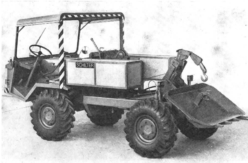
Abb. 2: Ansicht des Forstfahr- zeuges «Schilter». Es ist geschaffen für Mittel- lasten 2–3 m 3 (Grenz- werte: 4–5 m 3 ).
