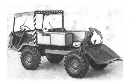
Abb. 2: Ansicht des Forstfahrzeuges «Schilter». Es ist geschaffen für Mittellasten 2–3 m³ (Grenzwerte: 4–5 m³).
