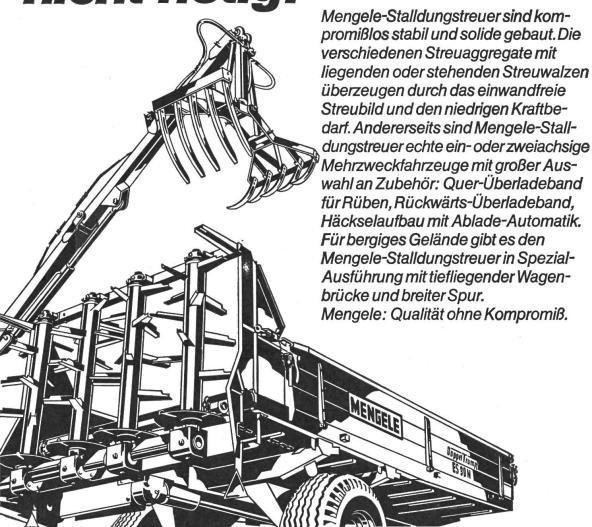
Sandri-Falco-Hydraulikkrane sind Maschinen, die in jeden modernen Betrieb passen. Lieferbar in verschiedenen Größen. Weite Ausladung, robuste Bauart und 1000 kg Tragkraft bei gestrecktem Ausleger sind die Vorzüge der Sandri-Hydrauliklader. Wirtschaftlich und vielseitig durch Silagegreifer, Rübengreifer, Kohlenschaufel, Erdschaufel, Sackzange, Holzzange, Tief-Drainagelöffel usw. Unser Prospekt sagt Ihnen mehr.
