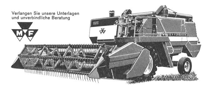
**MF 30:** 32 DIN PS-Motor 1,80 m Schnittbreite
