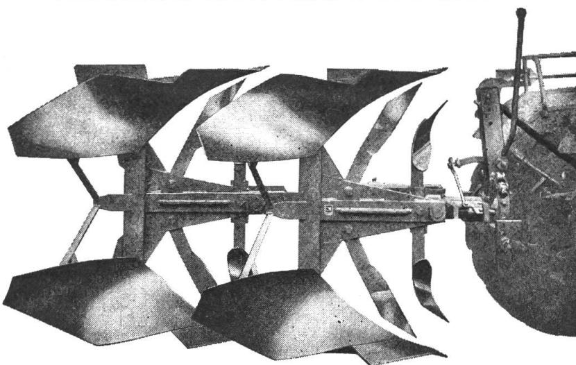
sind leichtzügiger und arbeiten besser. Tausendfachbewährte, unübertrifftene halbautomatische Wendevorrichtung. Grosser Durchlass zwischen den Pflugkörpern. Beide Furchen in der Breite genau einstellbar. Riestern aus chromlegiertem Panzerstahl, gegen Abnutzung besonders widerstandsfähig. Zuverlässige Bruchsicherungen.
