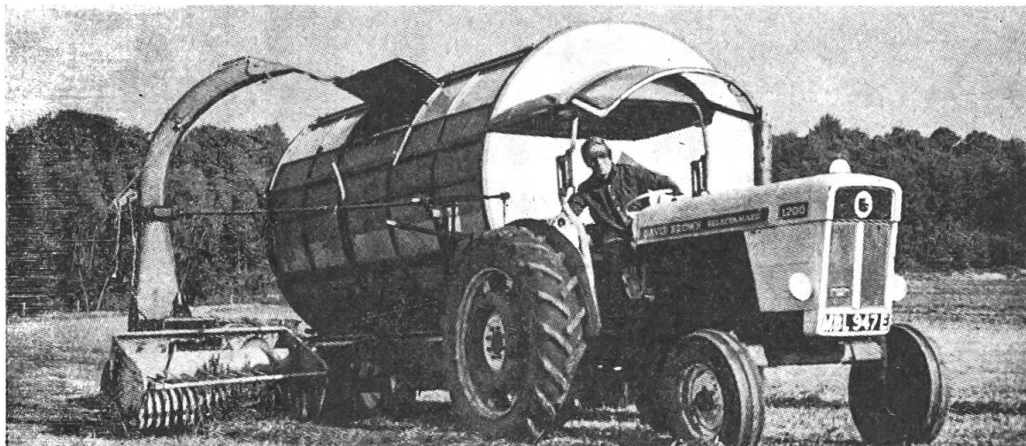
Abb. 9: Das Hayflaker-System. Ein trommelförmiger Behälter wird mittelst Feldhäcksler auf dem Feld mit Anwelkfutter beladen.
