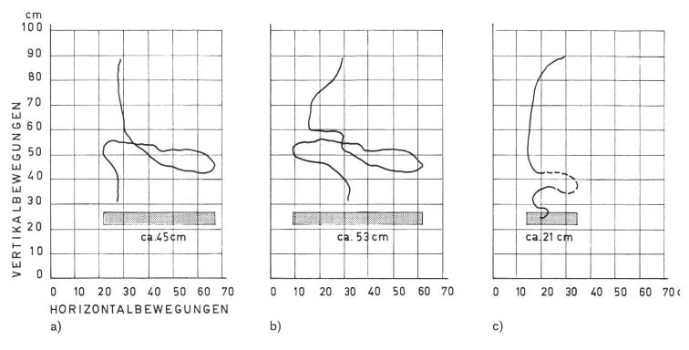
Abb. 9: Bewegung der Bugspitze beim Abliegen. a) und b) flexible Grabnerkette; c) Halsrahmen.
