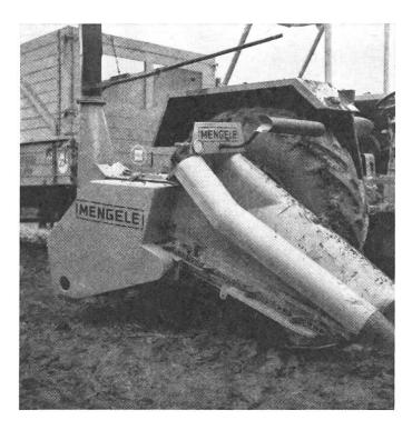
Abb. 1: Maiskolbenpflückschroter von Mengele. Er ist äusserlich kaum vom Anbauhäcksler zu unterscheiden.
