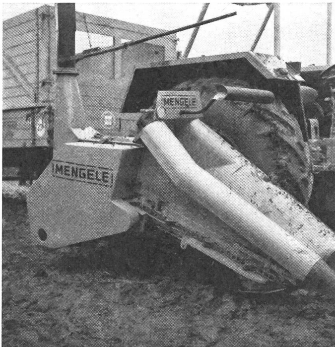
Abb. 1: Maiskolbenpflückschroter von Mengele. Er ist äußerlich kaum vom Anbauhäcksler zu unterscheiden.
