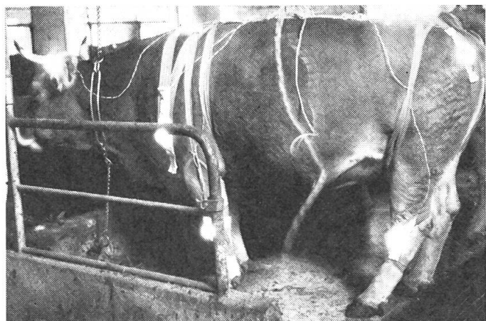
Abb. 4: Befestigung der Leuchtkörper an der stehenden Kuh, und zwar am Horn, Bugspitze, Vorderknie, Sitzbeinhöcker, Sprunggelenk. In der Mitte das Steuerkabel.
