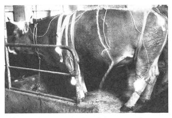
Abb. 4: Befestigung der Leuchtkörper an der stehenden Kuh, und zwar am Horn, Bugspitze, Vorderknie, Sitzbeinhöcker, Sprunggelenk. In der Mitte das Steuerkabel.
