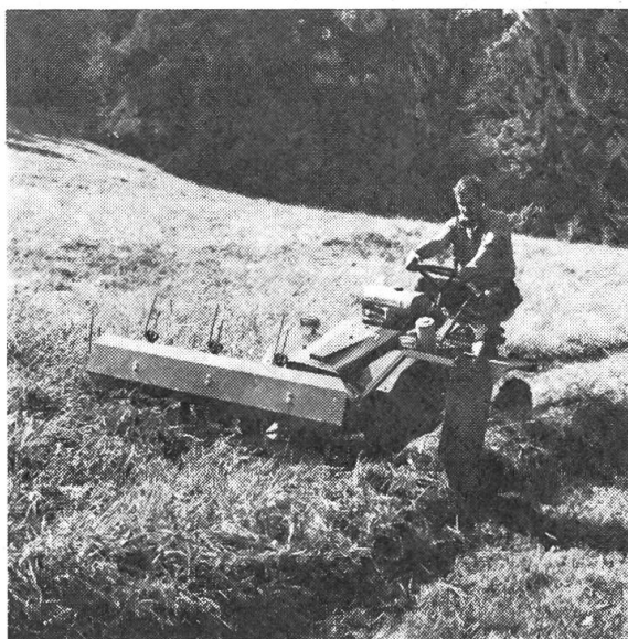
Bucher-Traktomobil M 700 S mit neuem fingerlosem Universalmesserbalken 2 m Arbeitsbreite und mit neuer Band-Eingrasvorrichtung.
