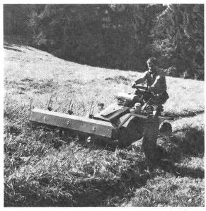
Bucher-Traktomobil M 700 S mit neuem fingerlosem Universalbalken 2 m Arbeitsbreite und mit neuer Band-Eingrasvorrichtung.
