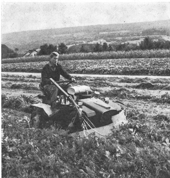
Bucher-Traktomobil M 700 S mit 190 cm Fingerbalken und herkömmlicher Eingrasvorrichtung.
