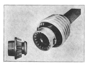
Abb. 1: Gelenkwellen - Schnellkuppler bestehend aus Profil-Kegel (links) und Kegel-Schnellkuppler (rechts). Walterscheid-Werkphoto
