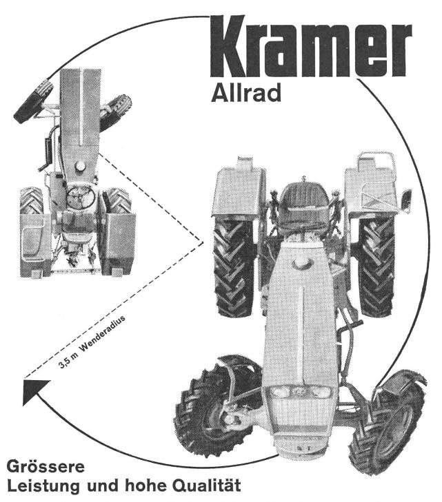
Der neue Kramer-Allrad kann die Zugkraft bis um 30% steigern. Der sehr grosse Lenkeinschlag von 60° bringt äusserste Wendigkeit bei knappstem Raum. Verblüffend einfach ist das Synchron-Lastschalt-Wendegetriebe zu bedienen. Einzigartig gelöst ist die oelhydraulische Vierradbremse und Einzelradbremse mit Vorwählung, ein wichtiger Faktor zur Unfallbekämpfung. Im Kramer-Traktor findet der Praktiker seine Wünsche erfüllt.
