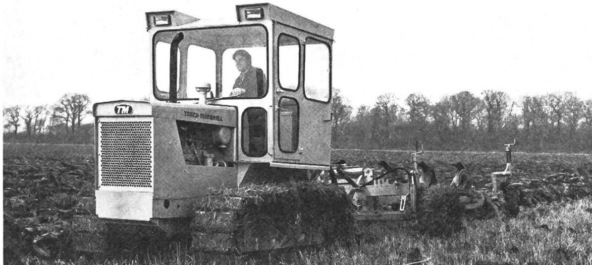
Der neue Raupentraktor TM 90 Track - Marshall. Trotz seines 90 to-Gewichtes soll der Bodendruck  $0,44 \text{ kg/cm}^2$  nicht übersteigen. Der Hersteller schreibt den neuen Raupenbändern zudem eine längere Lebensdauer zu.
