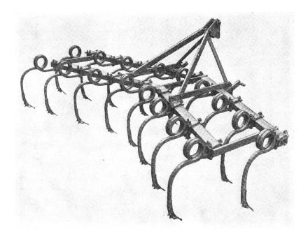
Abb. 2: Die mit starken Zinken ausgerüsteten Tiefgruben erreichen eine Arbeitstiefe bis ca. 30—40 cm und eignen sich angeblich gut zur Beseitigung der Bodendruckschäden.
