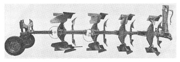
Abb. 1: Bei den französischen Pflügen wird auch häufig das Baukastensystem angewendet. Zur Vereinfachung der Konstruktion führt ebenfalls der Ersatz des Seches durch ein verlängertes Anlageblech (Pfeil).
