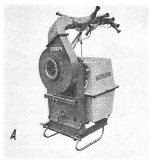
Abb. 8: Anbau-Sprühgerät «Pulverix» für Emulsions-Spritzmittel; Ausführung mit Baumspritzvorrichtung (A); daneben das gleiche Gerät ausgerüstet mit einem Feldspritzbalken (B).
