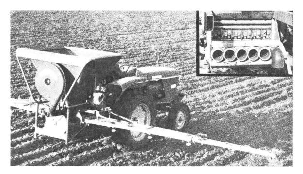
Abb. 7: Nodet-Breitdüngerstreuer bei der Arbeit; die Streuvorrichtung besteht aus zwei Dosierwalzen (1) und aus 6 verschieden langen Kunststoffrohren (2).
