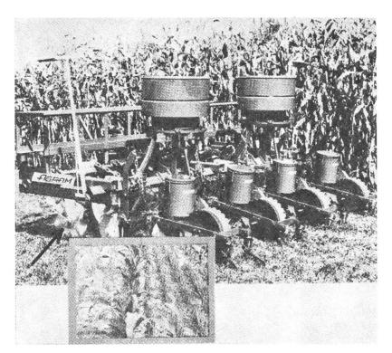
Abb. 5: Das Einzelkorn-Sägerät «Agram» ermöglicht die Maissaat in ein ungepflügtes Feld.
