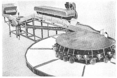
Die Maschine «Boulesteix» sortiert das Obst nach seinem Gewicht. Am Rande eines rotierenden Tisches sind Kippbecher angebracht. Abb. 11. Jeder Becher weist ein Gegengewicht auf, das während der Tischdrehung durch eine Führungsschiene dem Kipp-Punkt immer näher zugeschoben wird. Sobald das Drehmoment am Becherarm grösser wird als dasjenige des Gegengewichtes, kippt der Becher aus und das Obst fällt in ein entsprechendes Sortierfach. Die Sortierleistung beträgt pro Sortiertisch 800 bis 1000 kg/h.
