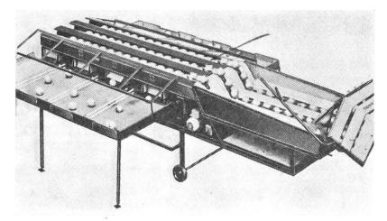
Abb. 10: Obst-Sortiermaschine «Fachaux», weist als Sortierorgan zwei entgegenrotierende Schneckenwalzen auf (Pfeil), die sehr genau und schonend arbeiten.
