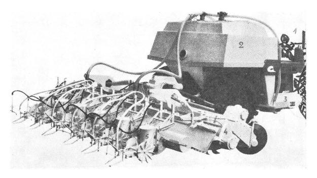
Abb. 4: Die für die Minimal-Bodenbearbeitung bestimmte Maschine «Cantone» verrichtet sämtliche Bestellarbeiten in einem Arbeitsgang. Auf der Abbildung sind ersichtlich:
