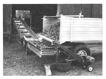
Abb. 6: Kartoffelumschlag mit Abladeteppich. Dieser lässt sich grundsätzlich an jedem Wagen mit ebener Brücke anbringen. Im Vordergrund rechts ist das stufenlos regulierbare Antriebsgerät sichtbar.
