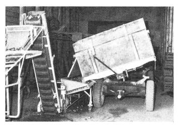
Abb. 4: Kartoffelumschlag mit Seitenkipper und Spezialförderband mit Stauschott.
