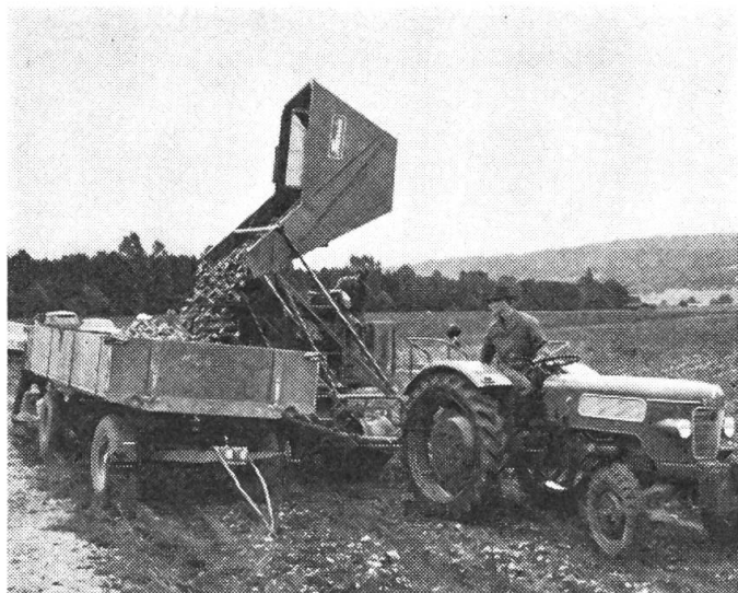
Abb. 1: Bunkervollernter, Abkippen der Kartoffeln in offene Kastenwagen.
