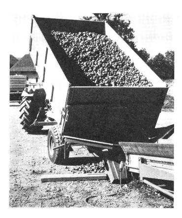
Abb. 3: Kartoffelumschlag mit Heckkipper und Förderband mit Grosstrichter.
