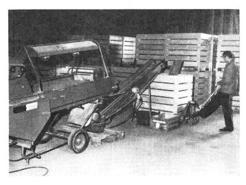
Abb. 7: Vorsortierung der Erntekartoffeln. Der Bedarf an Paloxen ist hier um 35–40 % geringer als bei direkter Beschickung mit umsortiertem Erntegut.
