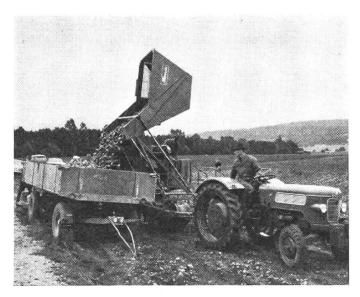
Abb. 1: Bunkervollernter, Abkippen der Kartoffeln in offene Kastenwagen.
