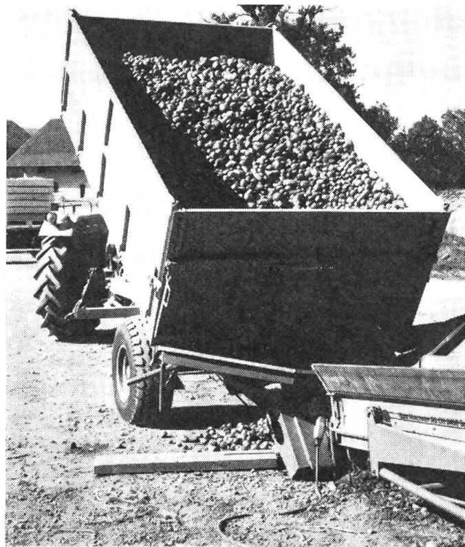
Abb. 3: Kartoffelumschlag mit Heckkipper und Förderband mit Grosstrichter.
