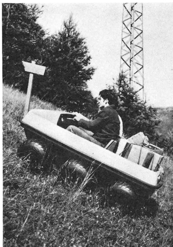
All-Gelände-Fahrzeug SOLO 750 25 PS, 60 km/h.
