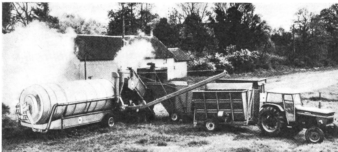
Abb. 7: Fahrbare Grastrocknungsanlage mit eigener Stromversorgung, die entweder auf dem Hof oder direkt am Feldrand aufgestellt wird. Der Preis soll ca. Fr. 225 000.— betragen.
