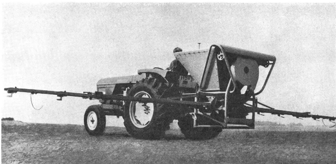
Abb. 1: Auch an der SIMA konnte ein starker Trend nach Grossraum-Landmaschinen festgestellt werden. 9 m breiter Düngerstreuer mit für den Transport aufklappbaren Armen.
