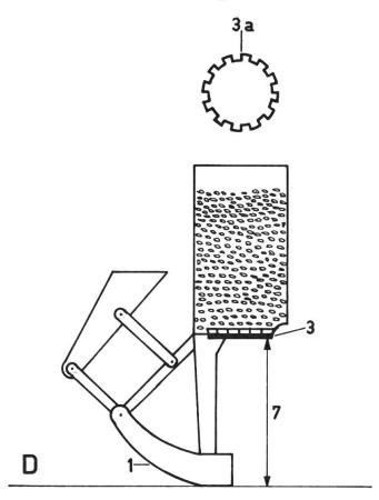
Einzelkornsägerät mit waagrecht eingebautem Säorgan
