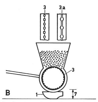
Einzelkornsägerät mit senkrecht angeordnetem Säorgan
