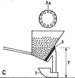
Einzelkornsägerät mit schräg angeordnetem Säorgan
