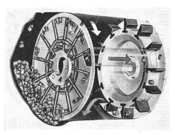
Einzelkornsämaschine John Deere 1240 Säscheibe mit Korngreifern
