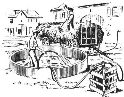
**AIV-Verteiler.** Die Lösung wird bei stabilem Wasserdruck automatisch im richtigen Verhältnis verdünnt und gelangt direkt aus der Säureflasche in den Silo.
