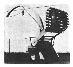
Siloentnahmefräse für Flachsilos («Fahrsilos»). Dieses Gerät wird am Traktor angehängt.
