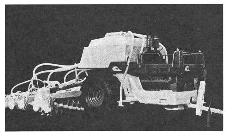
Gigantische Anhänge-Bodenbearbeitungs-, Spritz-, Dünge-, Sä-Kombination mit 300 PS Aufbaumotor.
