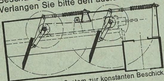
Patentiertes AMA-System zur konstanten Beschickung des Presskanals. Synchron laufende Gabeln führen die richtig dosierte Futtermenge gleichmäßig zu.
